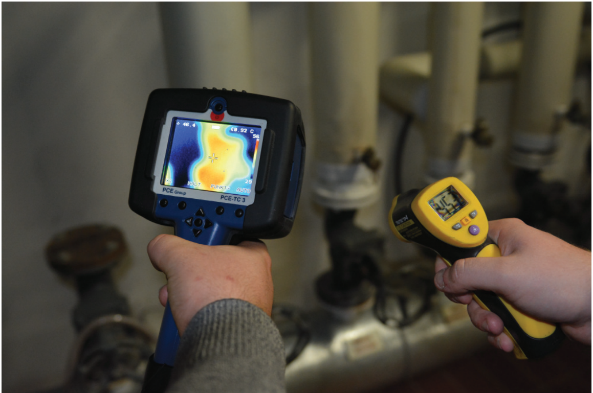
Abb. 1: Praxismodul im Schulgebäude - Messungen mit einer Wärmebildkamera
